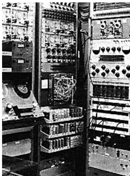
Figura 1: Sistema Groove (1970) desarrollado por Max Mathews J.C. Risset y Richard Moore para sintetizar sonidos musicales en tiempo real.
